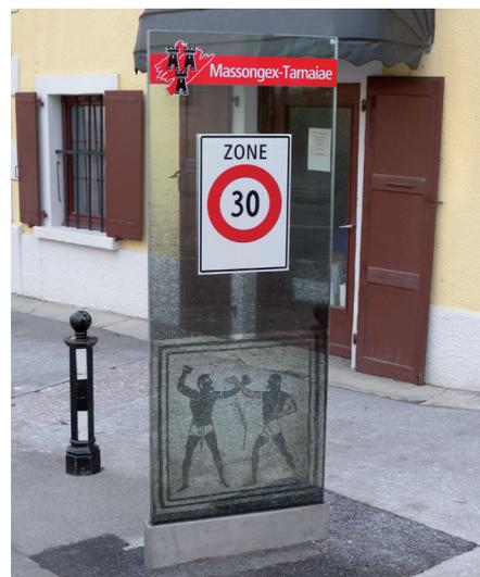
Les signaux, pour des questions de rétro réflexion, sont apposés sur les faces externes du verre. Au vu des conditions d'éclairage favorables rencontrées dans les zones où se situent ces totems, le matériel utilisé pour ces signaux est de type R2 ou HIP de la maison 3M. Une utilisation de matériel de type R3 ou DG3 de la maison 3M est bien entendu également possible.
